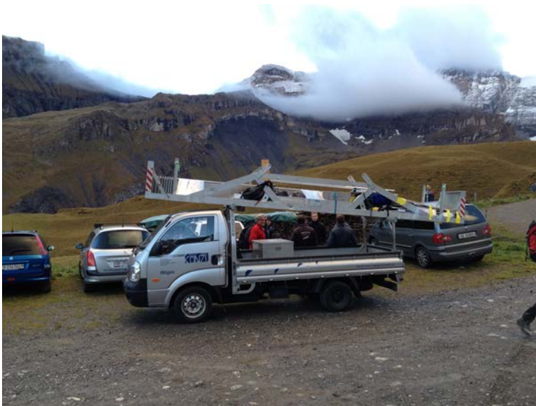
So werden die Alu - Bleche transportiert. 450 bis 500 kg.
